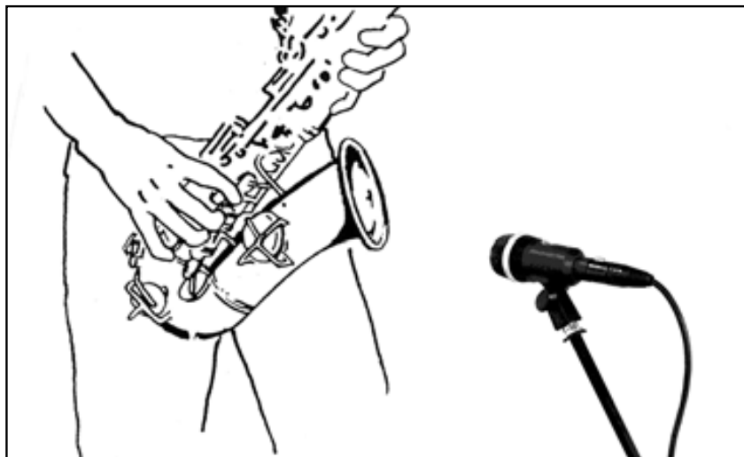
Fig. 1: Emplazamiento del micrófono para saxófono
