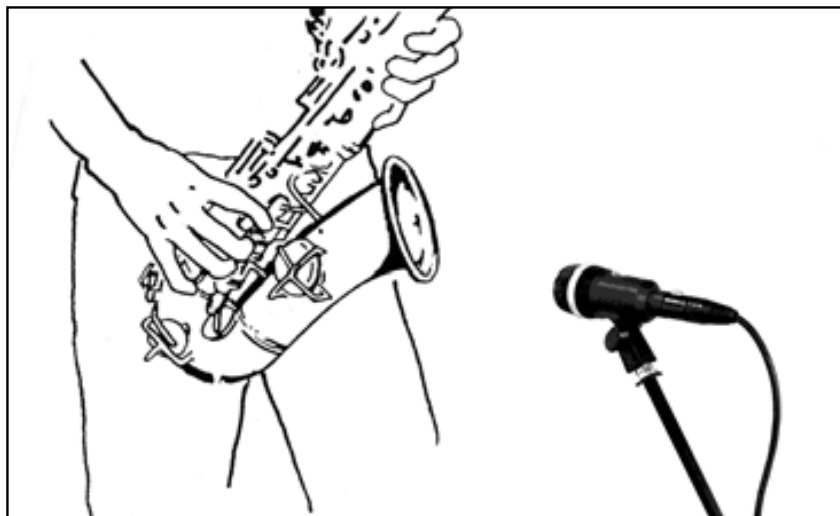
Abb. 1: Mikrofonaufstellung für Saxophon
