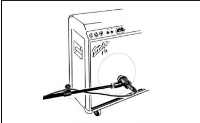
Fig. 3: Posicionamento do microfone para um amplificador de violão.
