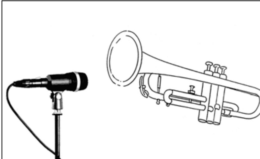
Fig. 2: Emplazamiento del micrófono para trompeta
