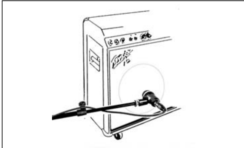
Fig. 3 : Position du micro pour amplis pour guitare
